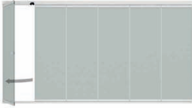
Simple opening by operation of a pull rod Apertura sencilla mediante una varilla de tracción
